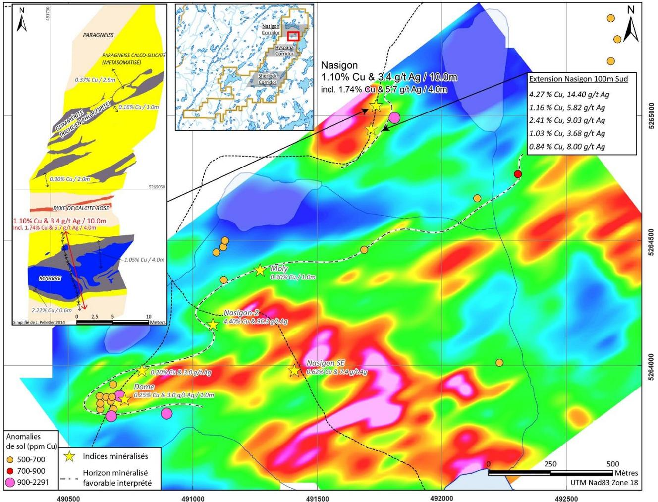
Figure 1: Plan de « chargeabilité » de la grille Nasigon à -25 m de profondeur avec localisation des indices cuprifère et des anomalies de sol. [L'image pleine grandeur peut être visualisée ici.](#)
